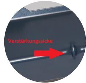
Die einzigartige Herstellung von Steirer Blech ermöglicht, dass der Schneeschutz in einem Teil aus dem Blech ausgestanzt wird. Dadurch sind die Eiskralen schon fix mit dem Blech verbunden. Zudem sind beim GS Schneeschutz schon werkseitig fixe EPDM Zellkautschuckdichtungen aufgebracht. Die eingepresste Sicke im Bereich der Bugkante verstärkt das Profil nochmal zusätzlich. Durch die Federwirkung wird das darunterliegende Dachmaterial nicht beschädigt.
